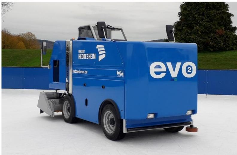
**Die neue, vollelektrische Eisaufbereitungsmaschine (eismaschine.jpg); Foto: Gemeinde**
